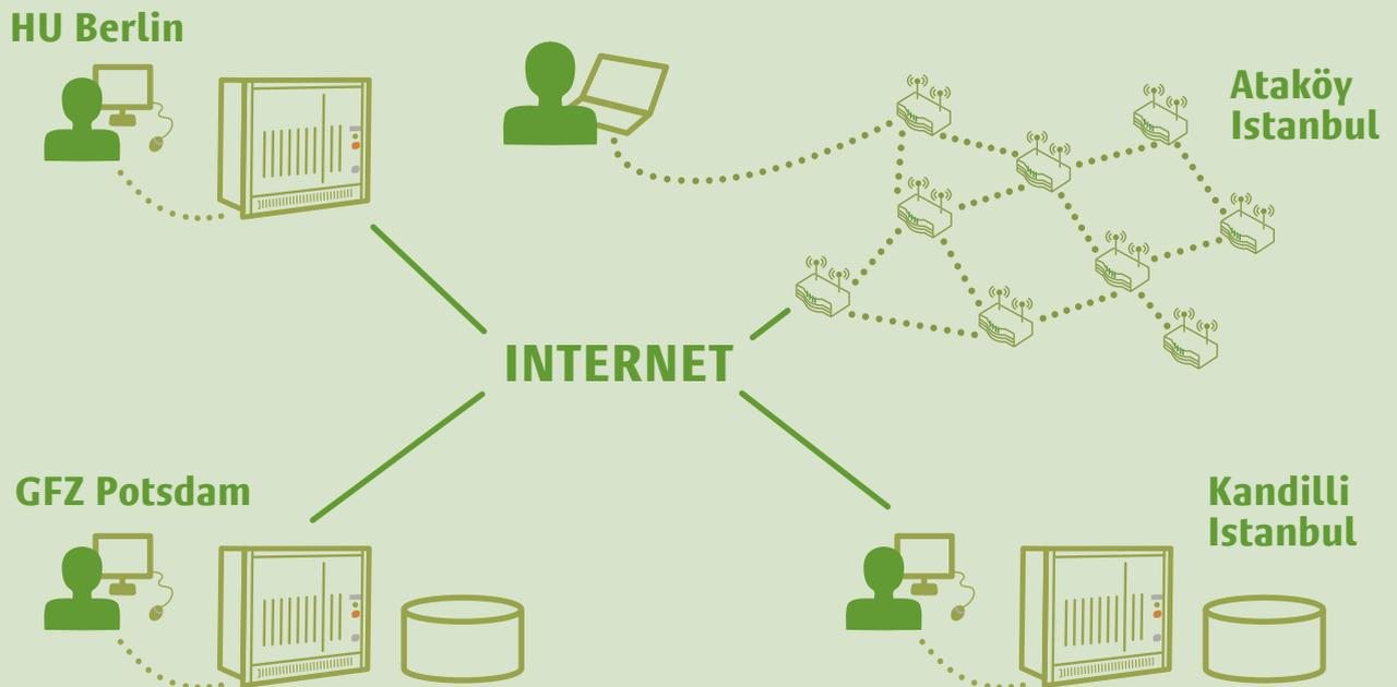
Zurück nach Istanbul, den Dächern von Ataköy und dem Netzwerk, in dem die in 100 bis 200 Meter Abstand installierten 20 Knoten drahtlos und selbstorganisierend miteinander kommunizieren und durch Sonnenenergie am Tage und von einer Batterie in der Nacht gespeist werden.
